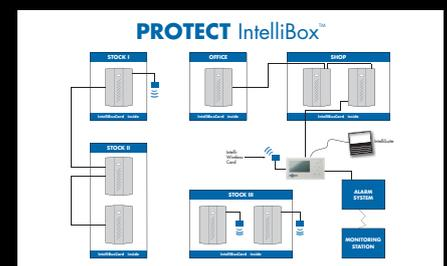
Voir au dos les exemples de trois différentes manières de connecter plusieurs Canon à Brouillard™ en utilisant le contrôle IntelliBox™.
