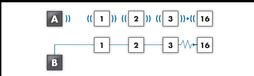
Chaque IntelliBox™ peut contrôler jusqu'à 16 générateurs de fumée. Selon le niveau de sécurité nécessaire, vous pouvez choisir entre une connexion sans fil A), une connexion par câble B), ou la combinaison des deux.
